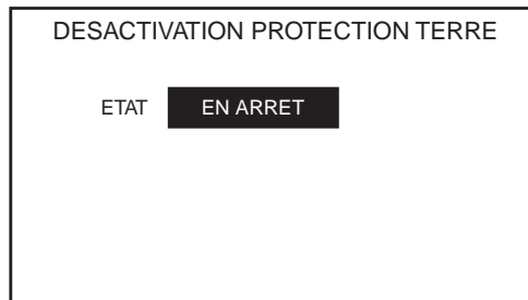
Figure 47 – Écran d'arrêt de désactivation protection terre
