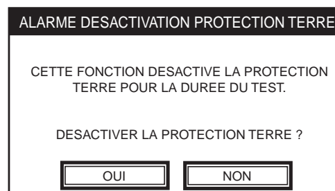
Figure 44 – Écran « Alarme désactivation protection terre »
